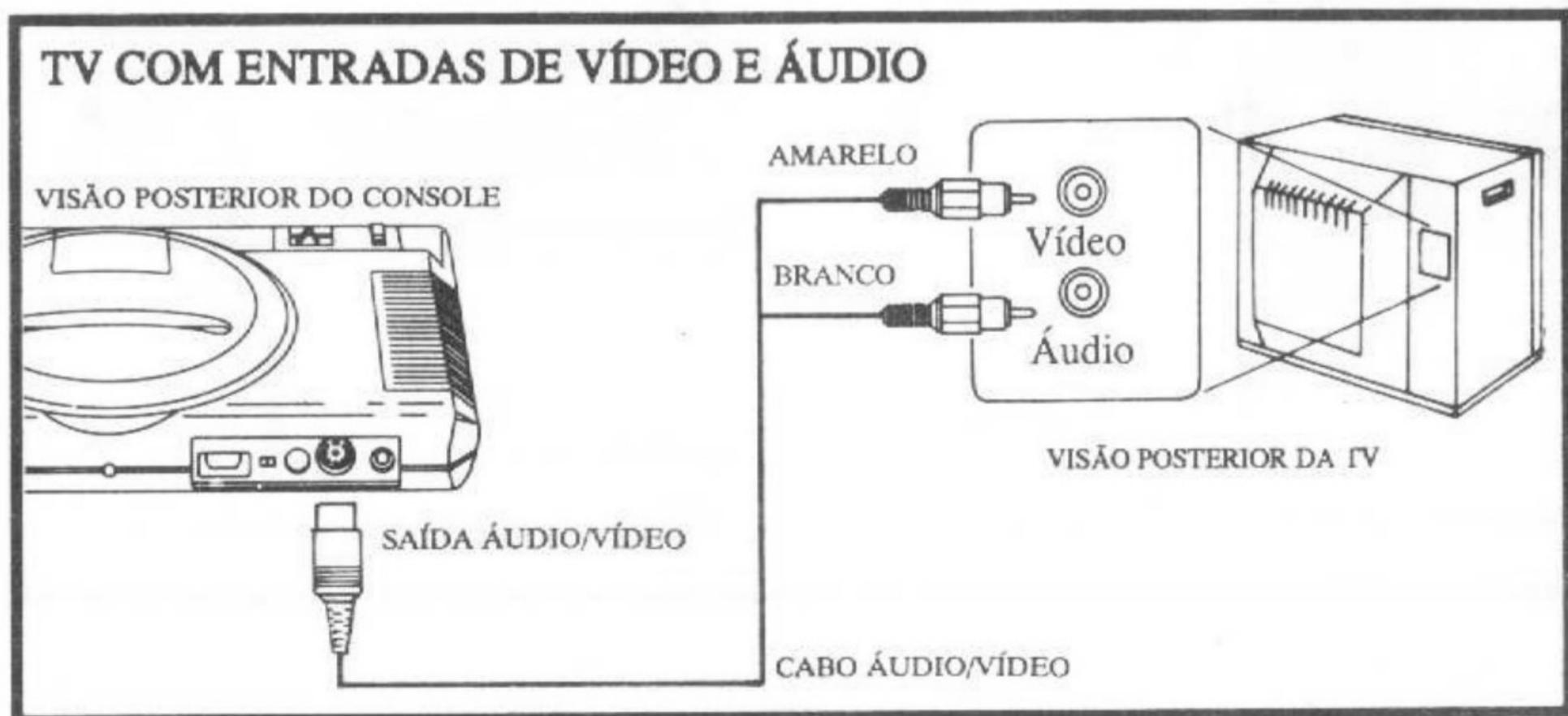
Se sua TV tem entradas de áudio e vídeo (geralmente na parte posterior de modelos mais recentes de TV), a conexão pode ser feita utilizando o Cabo de Áudio e Vídeo (vendido separadamente). Este cabo possui uma ponta com plugue DIN e outras duas pontas com plugue RCA (ver ilustração).
