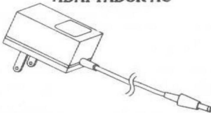
\* **ATENÇÃO** : O adaptador AC possui uma chave para selecionar a voltagem, 110V ou 220V. Sai de fábrica regulado em 220V. Certifique-se da voltagem de sua residência antes de ligar.
