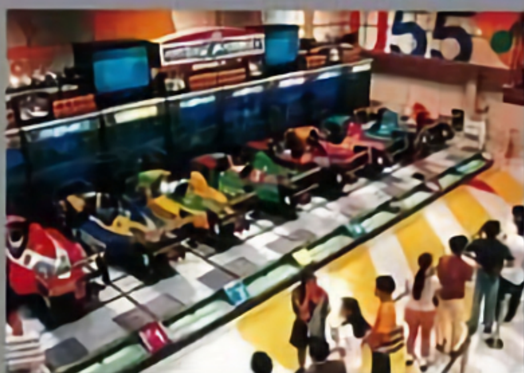
バーチャルフォーミュラ VIRTUA FORMULA リアルな3次元CGによるドライビング・シミュレーションマシン。上下左右に動くコックピット、タイヤのグリップや路面状況も再現するハンド感覚、さらにエンジンの回転に反応して振動も変化します。8人同時プレイが可能。
